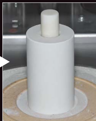
埋没およびワックス焼却後 プレスファーンズへセット
