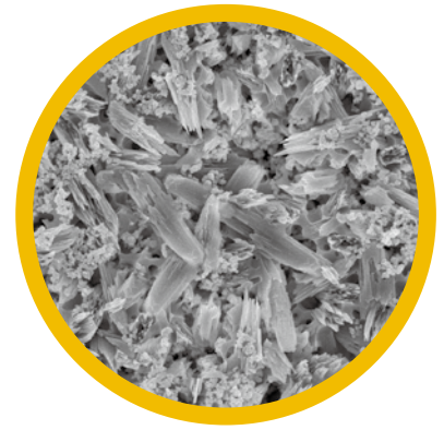
ナノ結晶相とマイクロ結晶相が共存することで高い曲げ強度を実現
